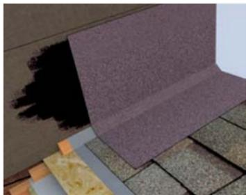
Ендовый ковер приклеивается на битумную мастику по аналогии с устройством прямого примыкания: на праймированную поверхность полоса заводится не менее чем на 300 мм, на рядовую черепицу – 200 мм.
