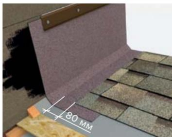
Механически закрепить металлический фартук. Произвести герметизацию фартука силиконовым, тиоколовым или полиуретановым герметиком. Гибкая черепица заводится на выкройку из ендового ковра таким образом, чтобы желоб между черепицей и галтелью был шириной 80 мм.
