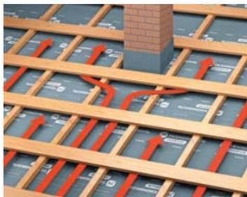
**ВАЖНО!** Необходимо обеспечить свободный проход воздуха в вентиляционном зазоре, для чего обязательно устанавливается разреженная обрешетка поверх контрбруса для вентиляционного зазора. Перекрытие мест движения воздуха не допускается. В случае использования дощатого настила в качестве
