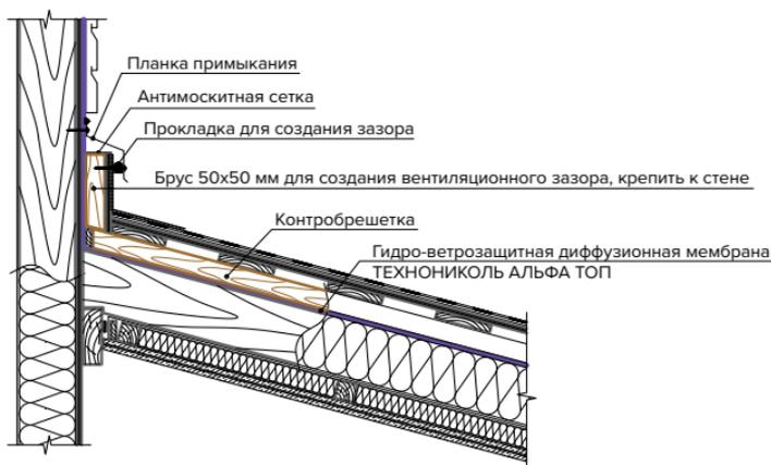
При примыкании кровли к стене также необходимо предусмотреть вытяжные отверстия.
