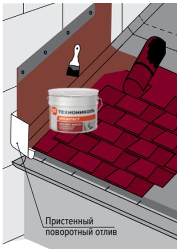
Если скат кровли заканчивается примыканием к стене, то примыкание необходимо выполнить с помощью ендового ковра, а конце ската установить пристенный поворотный отлив из ассортимента пластиковой водосточной системы ТЕХНИКОЛЬ.
